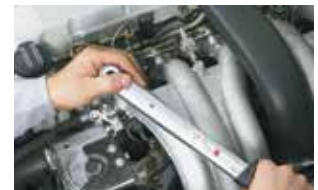
Remova e coloque as velas de incandescência APENAS com uma chave dinamométrica.
