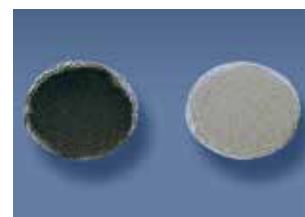
Depósitos de carbono no papel filtrante três minutos após o arranque a frio. Com o pós-aquecimento (à direita), os depósitos de carbono são aprox. 40% inferiores do que sem o pós-aquecimento.
