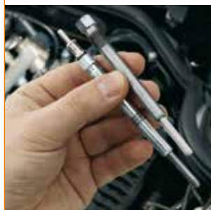
O escareador BERU – (RA003 – 0 890 100 003) liberta partículas geradas no processo de coqueificação que pode ocorrer após “cozedura” entre a vela de incandescência e a cabeça do cilindro.
